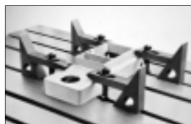
ステップクランプとステップブロックの組合せ
