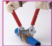
あご先端部分を使って排水トラップの取り付け・取り外しが可能。
