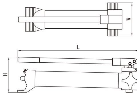
●高圧・低圧の二段自動切換の吐出型ポンプです。
