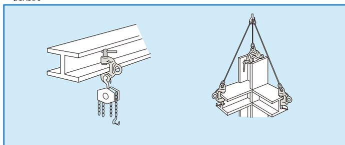
⚠ 吊上げの場合は、安全上必ず2点吊り以上を厳守して下さい。
