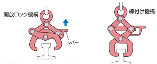
図の状態レール上に置きレバーを上げながら、シャックルを引き上げると爪は締まります。
