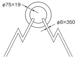
⚠ 長尺ものは安全上必ず天秤使用の上、2点吊りを厳守して下さい。
