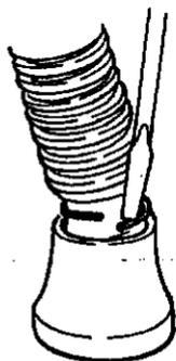
4. おねじを回すように傾き方向を変えながら順次止め輪を押込んでいって下さい。
