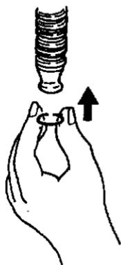
2. アダプタをおねじ先端部に取付けて図の様にねじの頭部を片手で持って台の上にアダプタを固定させて下さい。
