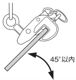
(7)湾曲した鋼板などの吊上げには使用しないで下さい。このような場合にはスクリーカムクランプ(SCC型)が最適です。
