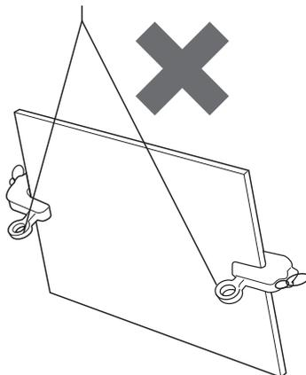
(6)吊り荷を斜めに吊上げる時は、水平に対し0°~45°迄として下さい。
