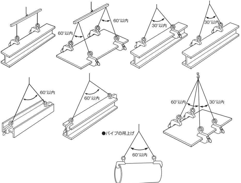
(4)本クランプでは立吊りはできません。立吊り作業には、必ず立吊クランプ又はスクリーカムクランプを使用して下さい。
