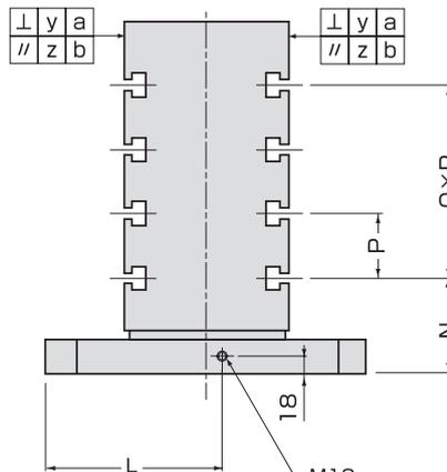
BRT32815の引きねじおよび取付穴のサイズ、位置はご注文通り製作致します。
