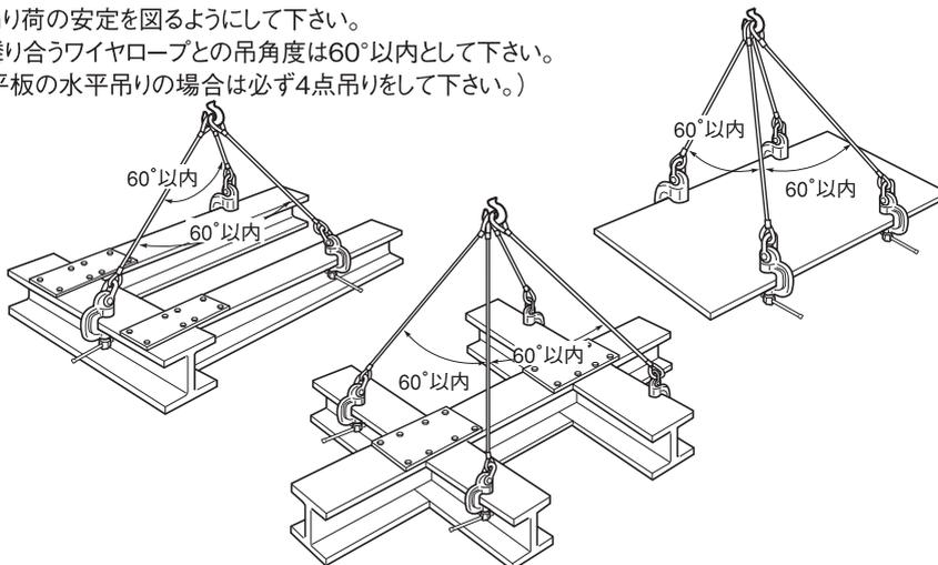
(3)型鋼などの一時的な反転(引き起こし)作業にも使用できます。
