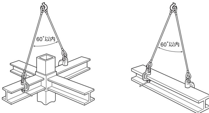
(2)形状の複雑なものを吊る場合はかならず3点吊り以上とし、クランプ位置やワイヤの長さで吊り荷の安定を図るようにして下さい。
