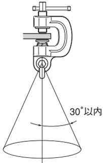
(2) ホイスト、チェーンブロック等の吊り下げ時にはつり環にUシャックル等を取付けて使用して下さい。
