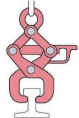
レバーを外すと自動的に締め付けロックが働きますので、図の状態で吊上げて下さい。
