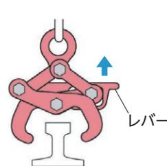
図の状態ではレール上に置きレバーを上げながら、シャックルを引き上げると爪は締まります。
