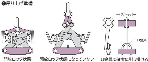
クランプを吊り上げ上図のような開放ロック状態になっているか、確認して下さい。開放ロック状態になっていない場合は、ストッパーを本体のU金具に引っ掛け、再度吊り上げると開放ロック状態になります。
