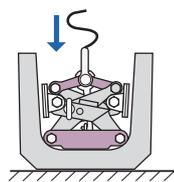
U字溝を所定の位置に搬送後、U字溝が確実に安定したか確認の後、ワイヤロープが完全にゆるむまで巻き下げて下さい。
