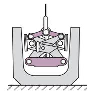
ストッパーをU金具に引っ掛け再度吊り上げると、クランプが開放ロック状態となり、クランプのみが移動でき次の作業へ移ることができます。
