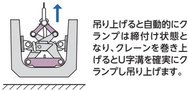
吊り上げると自動的にクランプは縮付け状態となり、クレーンを巻き上げるとU字溝を確実にクランプし吊り上げます。
