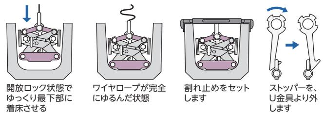
開放ロック状態にしたクランプをU字溝の上に移動し、ワイヤロープが完全にゆるむまで最下部に着床させます。次に割れ止めをクランプのすぐ横にセットします。この時、割れ止めのアーム面がピッタリとU字溝につくように、本体にある取っ手を回転させしっかりと締めます。次にストッパーをU金具より外します。これで吊り上げ可能となります。
